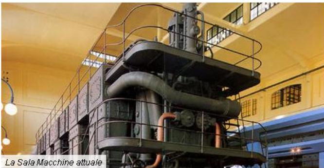
Nella sala macchine ci sono due motori Diesel. Ogni albero motore pesa 81 tonnellate (= 80.000 chili) e misura più di 20 metri. C'è anche una turbina a vapore.
